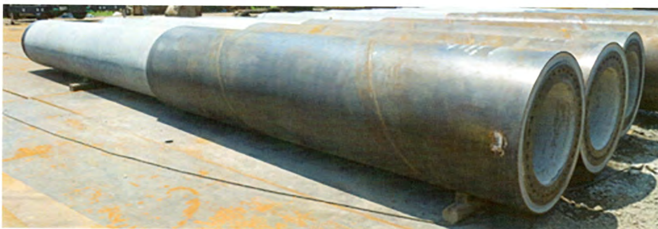
SPHC杭製造後出荷待ち
